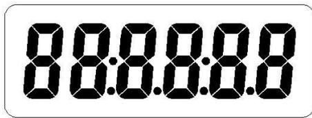
6 stellige Zählwertanzeige für +A (Energiebezug). Die Einheit kWh ist rechts neben der Anzeige auf dem Gehäuse dargestellt
